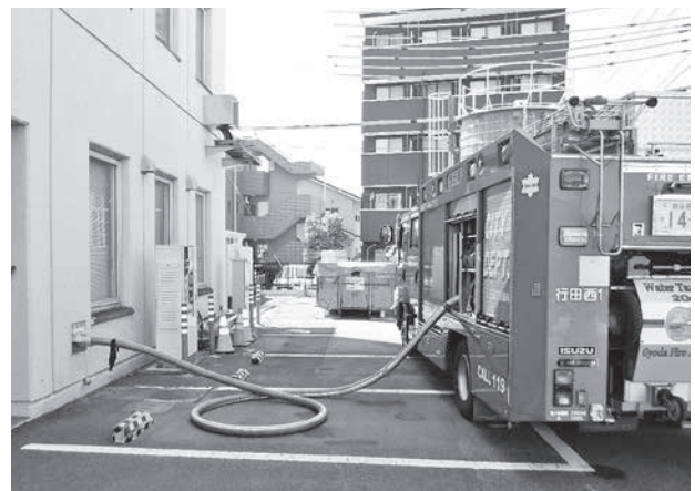
コミュニティタンクから水の供給を受けている様子
