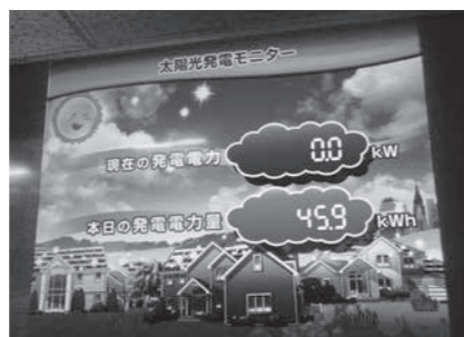
中学校に設置された太陽光発電モニター
