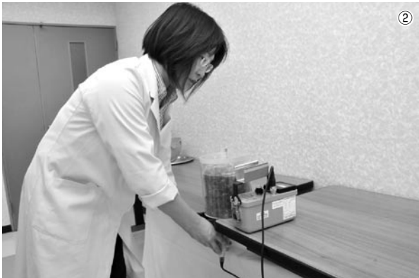
①簡易型放射線測定器/NaI(Tl)シンチレーションサーベイメーター ②食材の測定を行う
