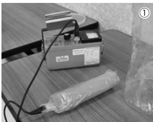
①簡易型放射線測定器/NaI(Tl)シンチレーションサーベイメーター ②食材の測定を行う
