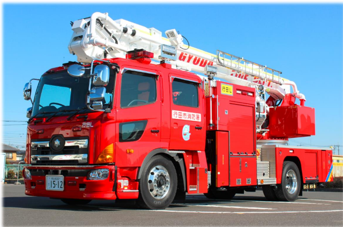
【25 めーとる メートル級 きゅうくっせつ 屈折はしご付き しょうぼうじどうしゃ 消防自動車】
