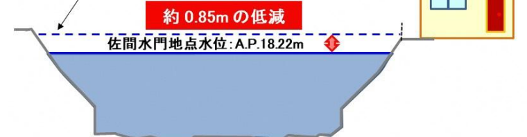
佐間水門の出水取込みによる忍川の水位低減効果※1
