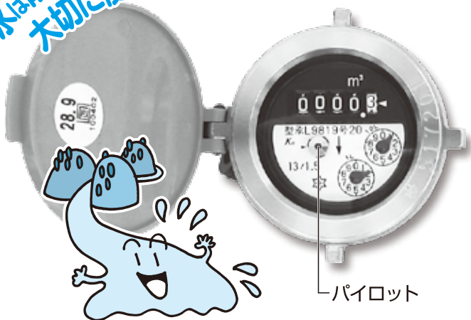
水道メーター
