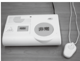
緊急通報システム
